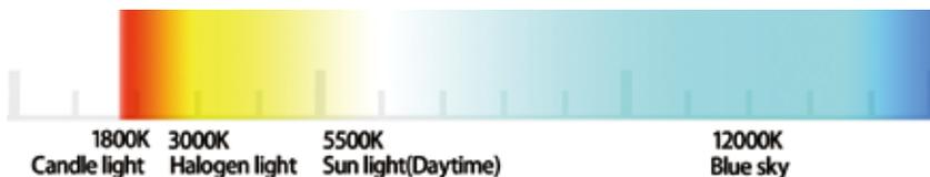
図 3.1.4 ろうそくの炎 (約 1,800 K)、ハロゲン電球 (約 3,000 K)、太陽光 (約 5,500 K)、青空 (約 12,000 K)
